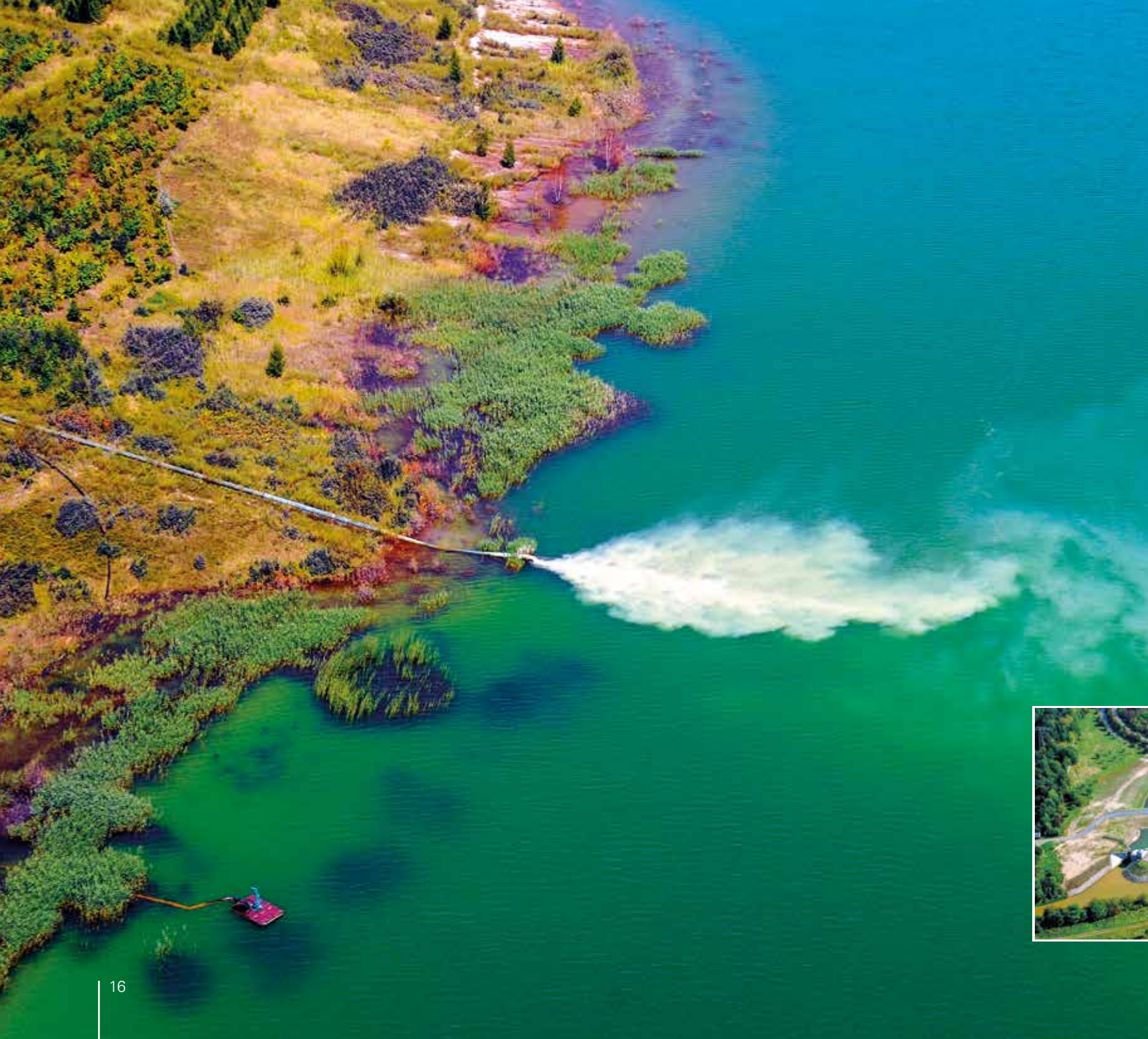
Einleitung von Kalkmilch zur Neutralisation des Hainer Sees, 2009
