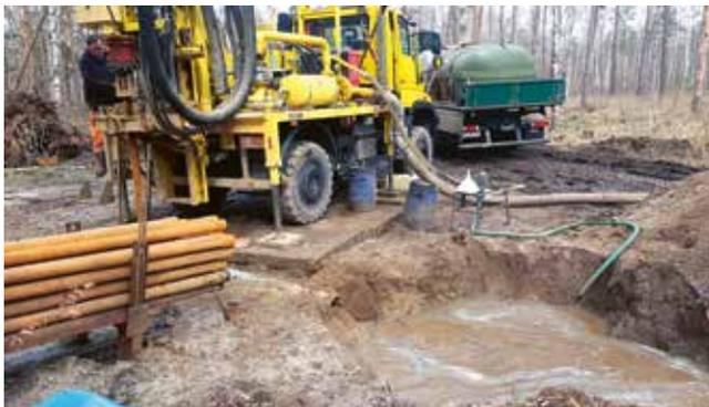
führt werden. Im IV. Quartal 2023 konnten die letzten drei von insgesamt sechs Entnahmebohrungen mit einer Tiefe von bis zu 30 Meter durchgeführt werden, sodass die Maßnahme beendet wurde. Alle gewonnenen gefrorenen Bodenproben wurden in thermoisolierten Behältern bis zum bodenphysikalischen Labor transportiert und für die geforderten Untersuchungen übergeben.
