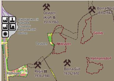
Der Tagebau Kraft II, später Deutzen, wurde 1911 westlich der Ortslage aufgeschlossen. Ein Jahr später ging die Brikettfabrik I in Betrieb. Die Brikettfabrik II und die Schwelerei folgten 1914 bzw. 1937. Die Förderung endete 1960 nach knapp 50 Jahren. Die Siedlung Altdeutzen wurde erst Anfang der 1960er Jahre durch den Tagebau Borna-Süd beansprucht.
