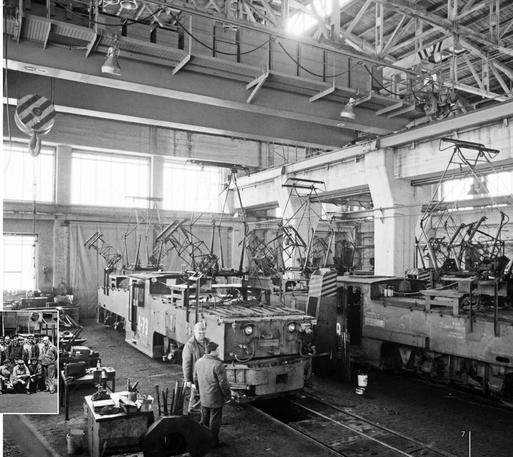
Elektrische Grubenlokomotiven EL 3 in der Werkstatthalle der Tagesanlagen des Sanierungstagebaus Nachterstedt, 1996
