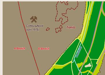
Die Abbaurichtung des 1978 in Betrieb genommenen Tagebaus Cottbus-Nord verlief von Nord nach Süd. Zwischen diesem und dem Tagebau Jänschwalde verblieb ein unverritzter Korridor, auf dem die Bundesstraße B97 und die Grubenbahnen verliefen. 1982 erreichte der Tagebau Tranitz, das vollständig in Anspruch genommen wurde.
