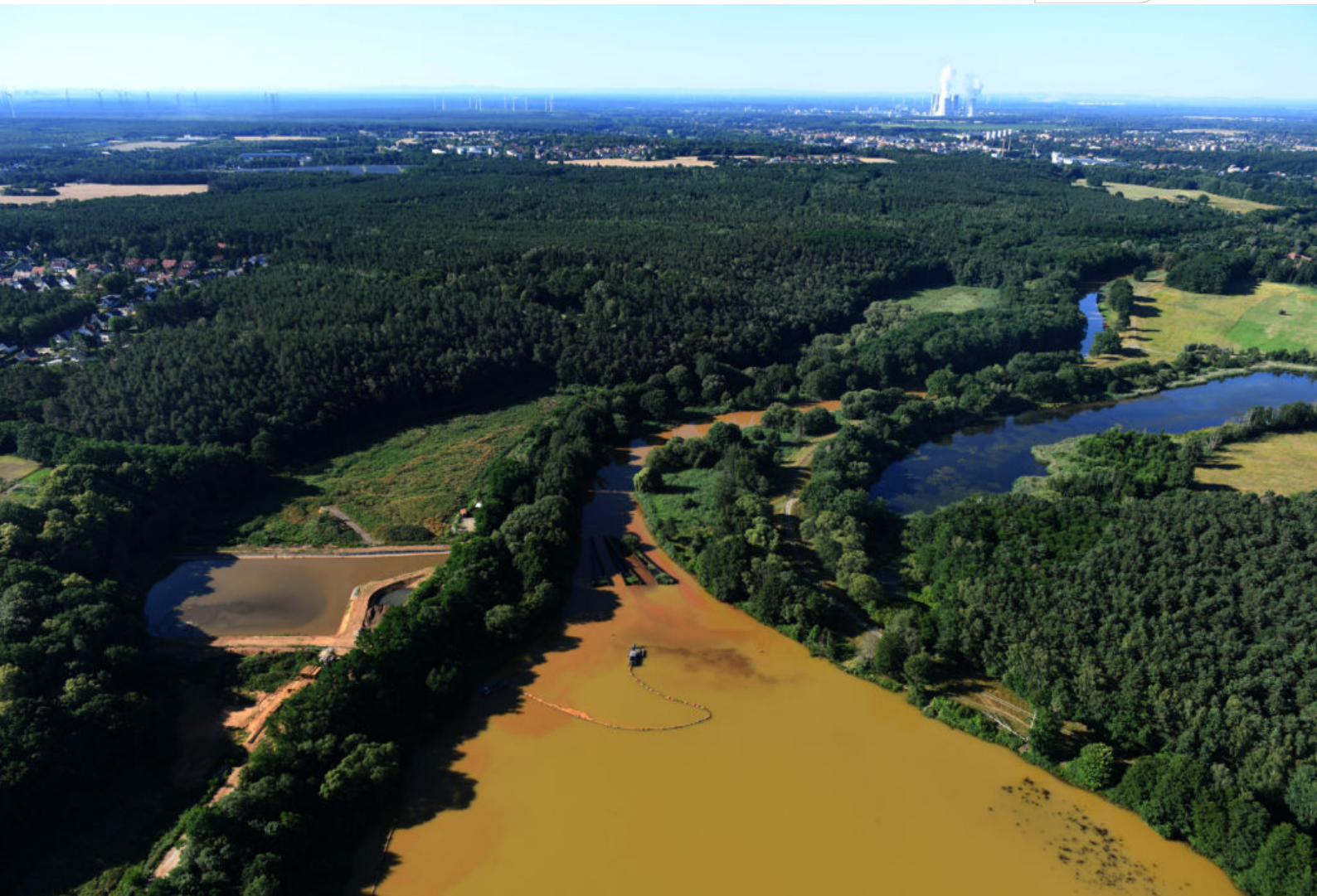
Saug-/Spülbaggern: EHS-Sedimentation am Zulauf zur Vorsperre sichtbar | Juli 2020
