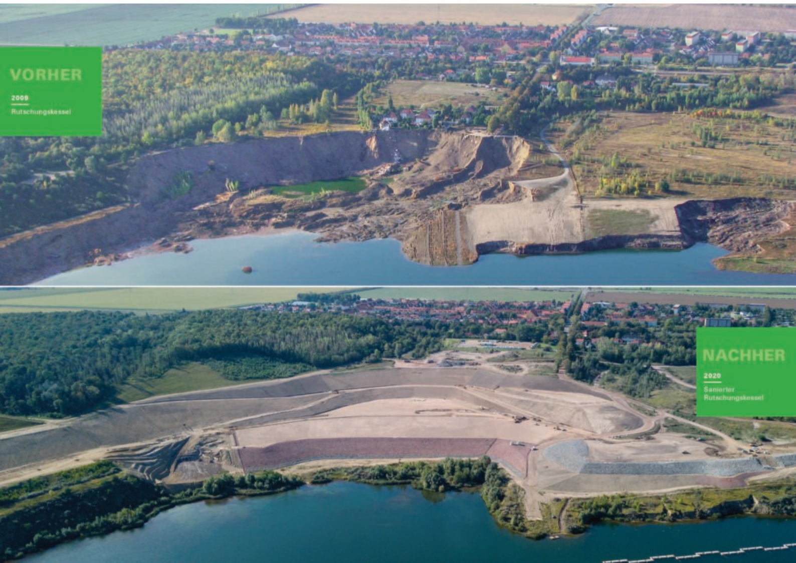
Vergleichsfotos vom Haupttrutschungskessel vor und nach der LMBV-Sanierung (LMBV/Peter Radke 2009, LMBV/Christian Horn 2020)
