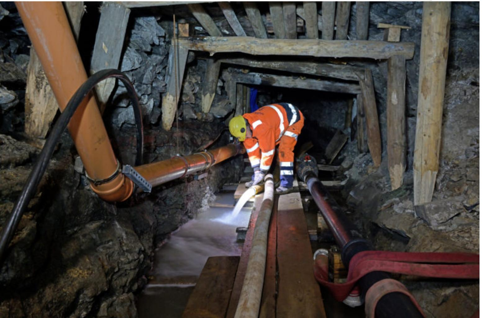
Das überschüssige Wasser wird über ein Pumpensystem in den Seegen-Gottes-Stolln gehoben.
