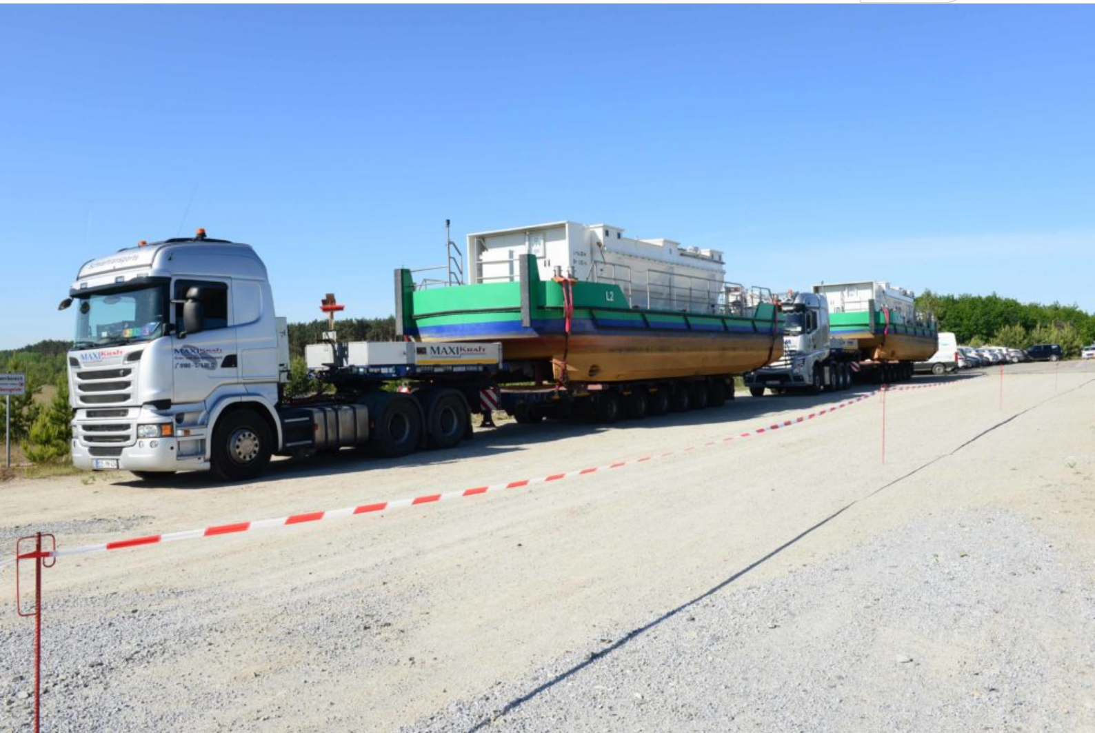
Anlieferung des Schiffes mit Schwerlasttransport am Sedlitzer See
