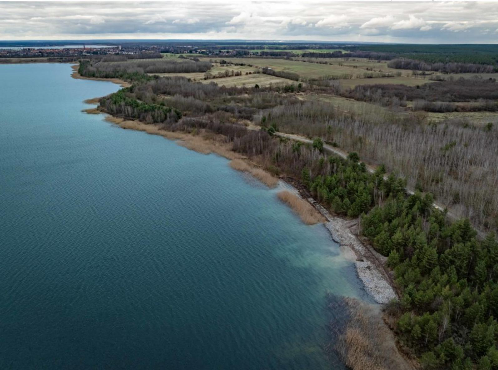
Die erodierte Uferlinie am Ostufer. Am ersten Abschnitt wurden bereits Wasserbausteine aufgeschüttet.
