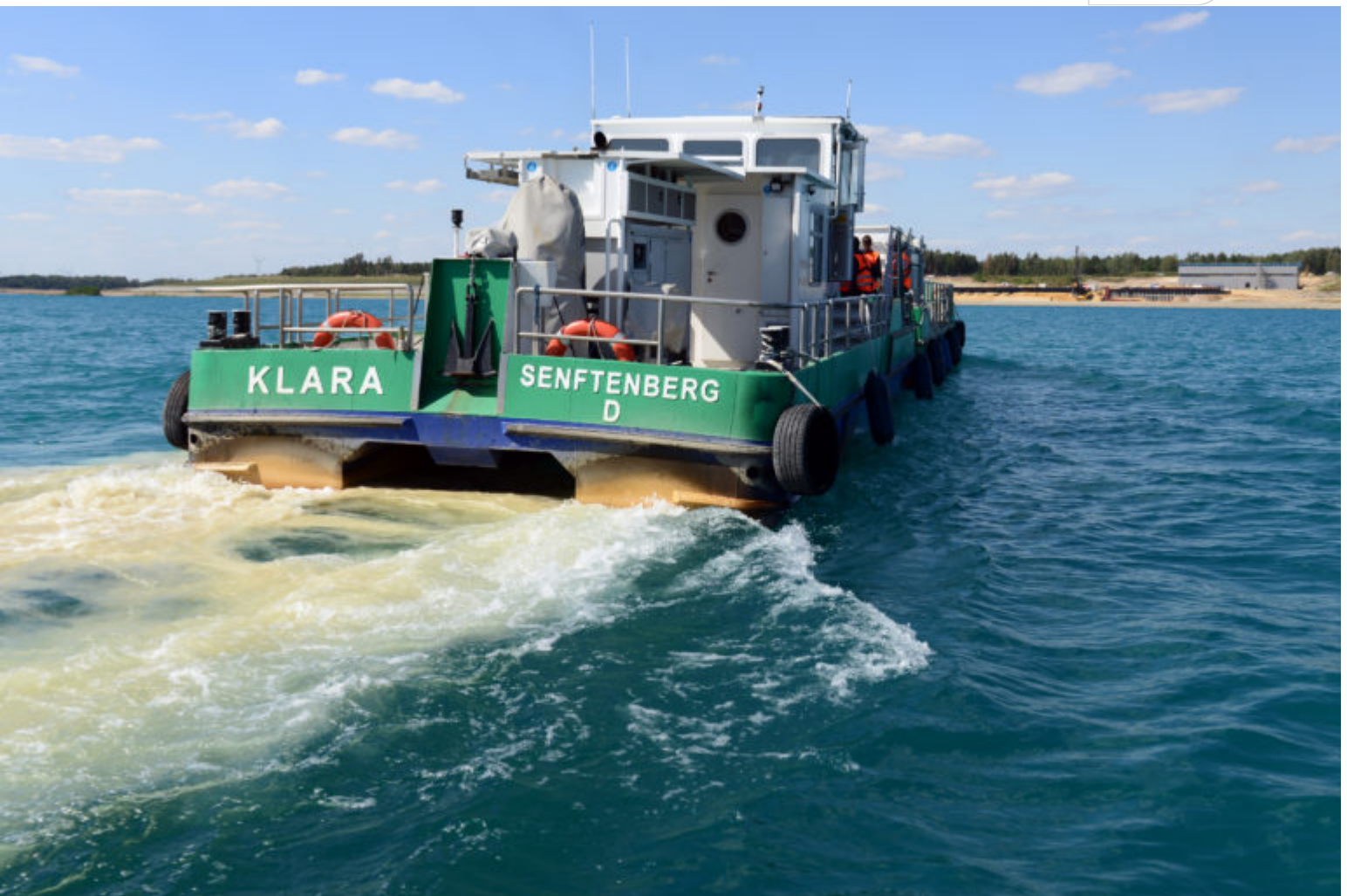
Gütwasserbehandlungsschiff der LMBV im Einsatz auf dem Sedlitzer See
