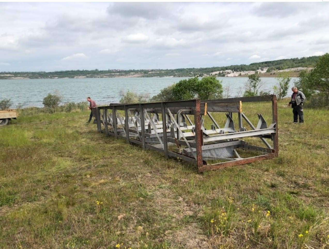
Zehn-Meter lange stählerne Auflaufbrücke, einst Teil des Kohleförderband-Trägers (Foto: Werner Müller)
