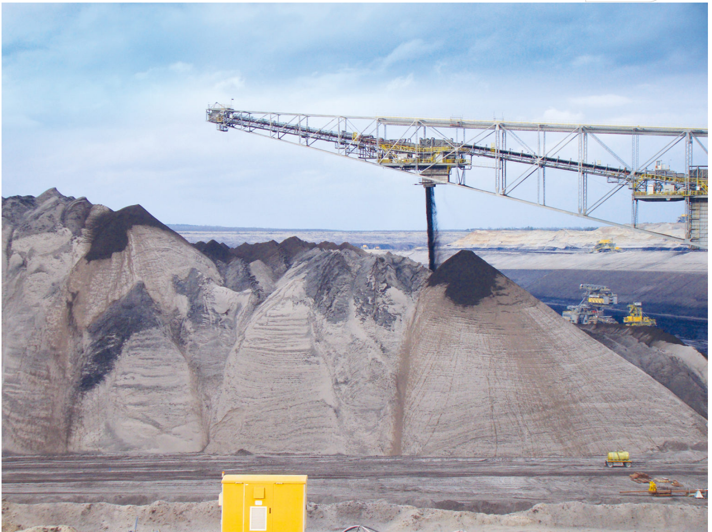
Abraumförderbrücke im Tagebau Nochten (LEAG)
