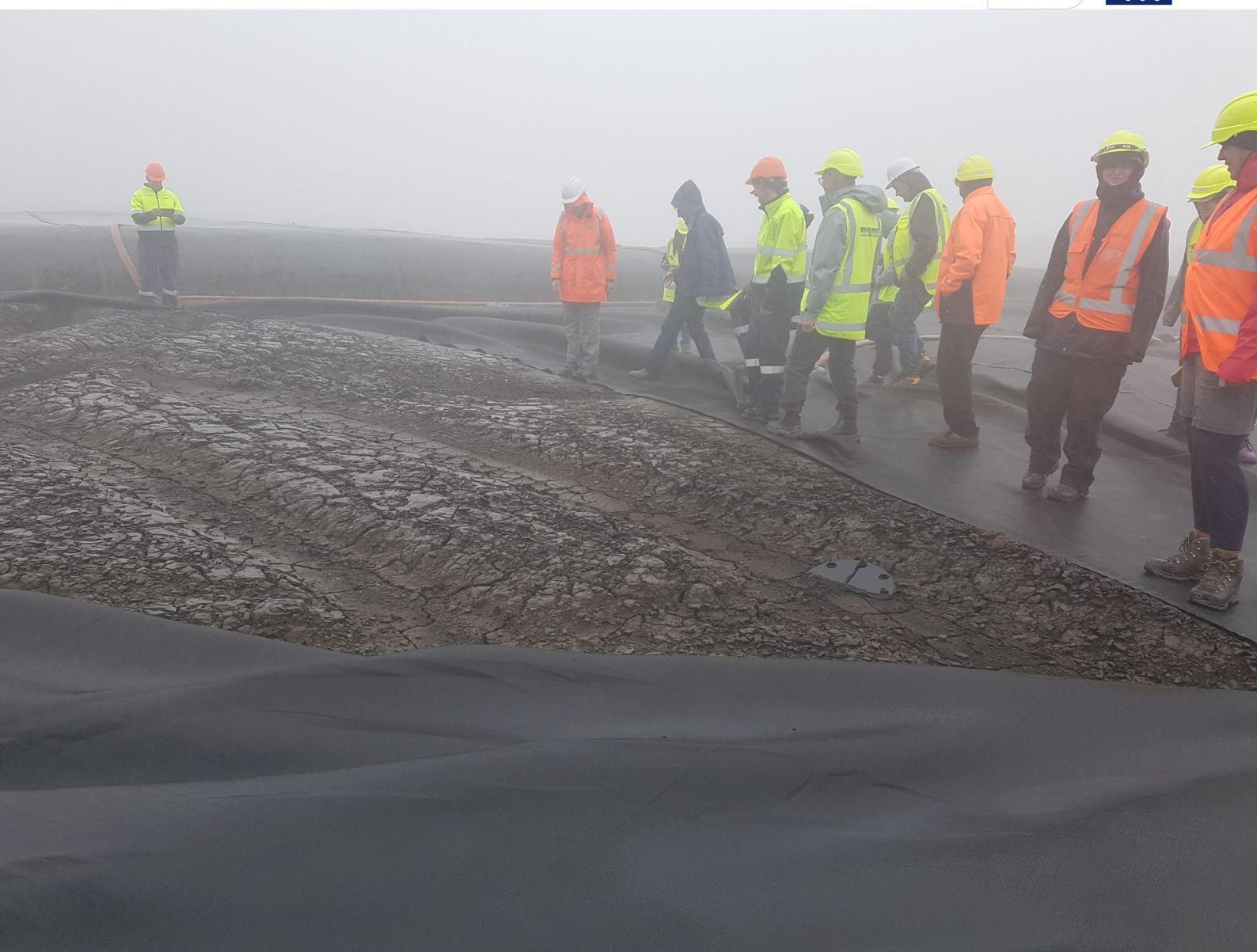
IMWA-Tourpunkt: Schlamm-trocknung in Geotubes in der "Stockton Coal Mine"
